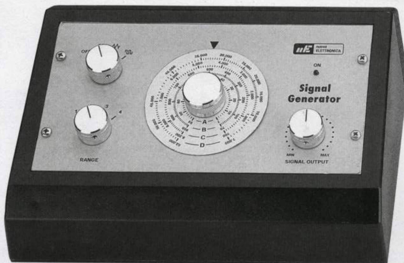
Fig.1 Foto del Generatore BF completo di mobile.
