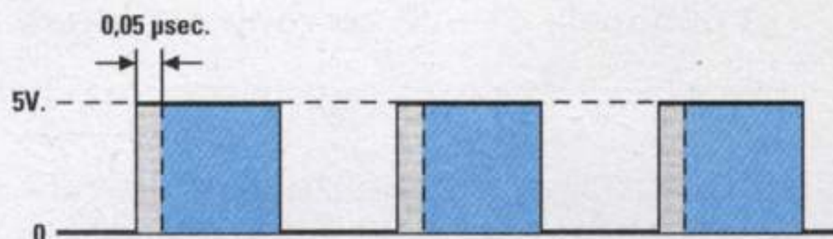
Fig.5 Per leggere sui display l'esatto valore del condensatore dovremo eliminare, in fase di taratura l'impulso di 0,05 μS presente su ogni impulso, diversamente lo stadio integratore ci fornirà una tensione maggiore di 0,35 volt.
